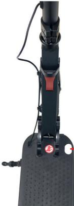
Auf dem Deck befindet sich rechts vorne eine Öffnung. Verwenden Sie ein handelsübliches Fahrradschloss (nicht im Lieferumfang enthalten), um den E-Scooter vor Diebstahl zu sichern, .
