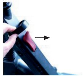
2. Klappen Sie die Lenkstange auf / zu, bis sie hörbar einrastet.
