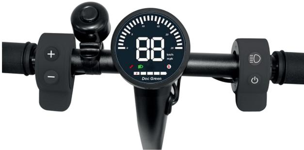
Schalten Sie mit der Taste
